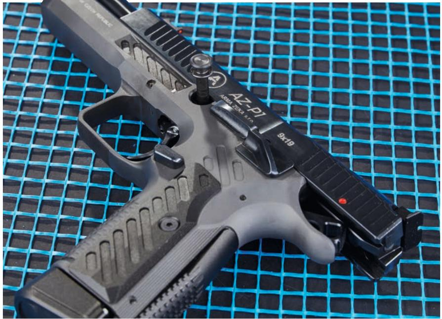
Die Verschlussachse ähnelt handhabungsseitig einem Druckknopf und kann nicht aus dem Griffstück entfernt werden - ein Plus bei Zwischenreinigungen auf weitläufigen Außen-Schießständen. Den Verschluss fängt der mittlere Hebel nun monofunktional.
