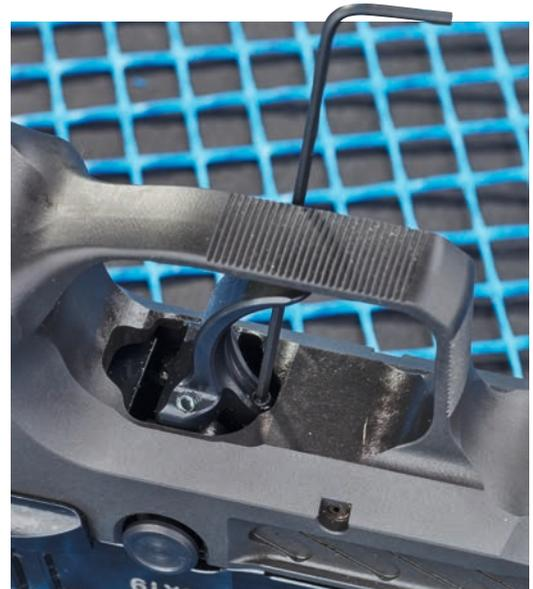
Sowohl der Vorzug wie der Rückstellweg des Abzugs ist an beiden Modellen einstellbar. Die Abzugscharakteristik und der Widerstand lassen den Einsatz ohne weitere Überarbeitung zu.
